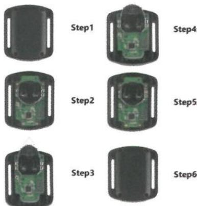
**Fase 1:** utilizzare un cacciavite a punta da 1,84 mm (non incluso) per rimuovere le 4 viti sul coperchio posteriore, che consentiranno di aprire il coperchio posteriore.
